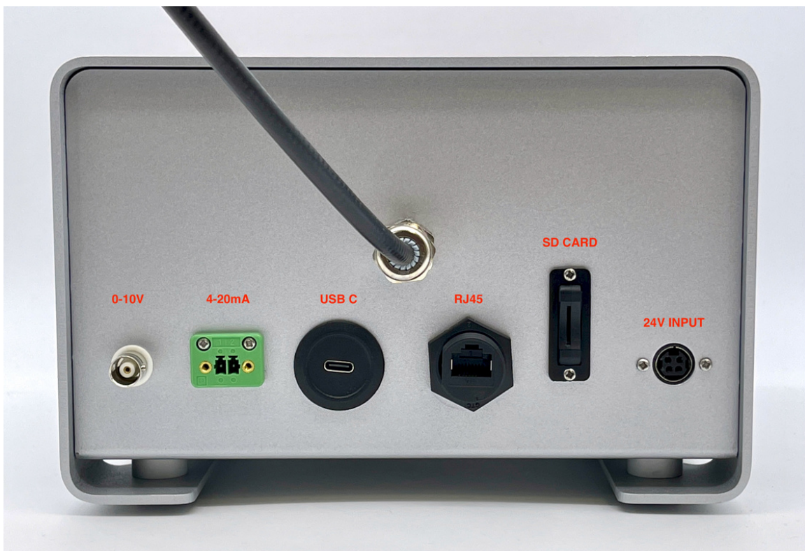
La face arrière avec sa connectique
